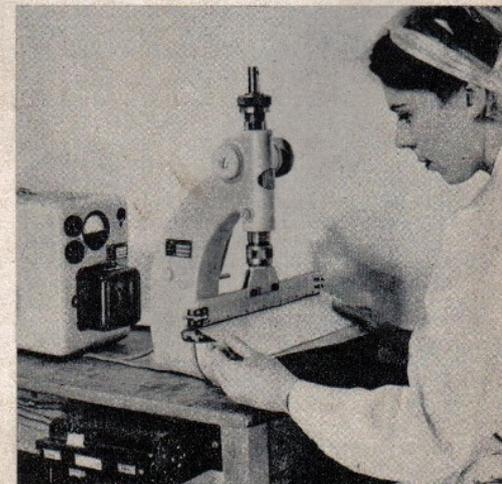
Lorenz-Wärme-Impuls-Schweißplatz, links vor der Schweißpresse das Netzgerät, darunter Regelwiderstand Werkfoto
