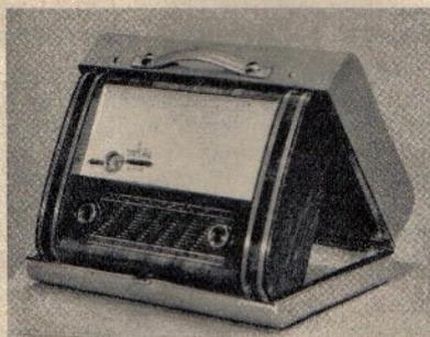
ist organisch in die Schaltung eingebaut und arbeitet mit Flankengleichrichtung. Übrigens wird separat auf Wunsch ein Zerhackerteil in einem Kästchen mitgeliefert, so daß die „Reise-Violetta“ auch an der Autobatterie betrieben werden kann.
